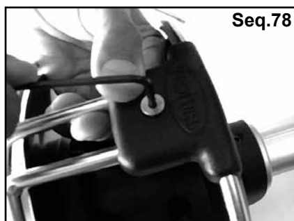
Dévisser les vis de liaison. Unscrew the drum cage connectors.
