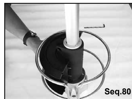
Dévisser les vis de tambour. Unscrew the drum screws.
